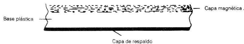
Figura 6.1 Corte seccional de la cinta de audio.
