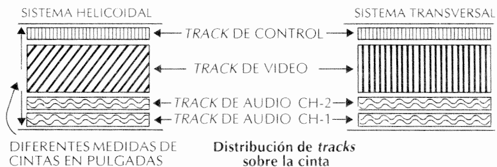
FIGURA 12.2. Distribución de pistas o tracks sobre la cinta.
