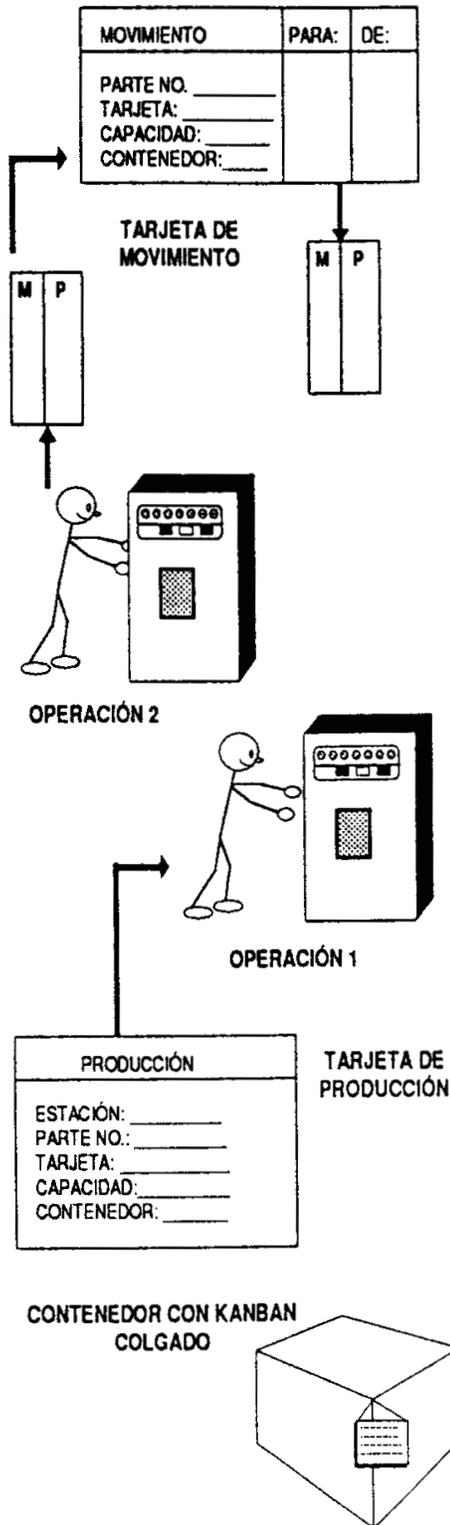
1. El operario dos necesita material, le lleva una tarjeta de movimiento al operario uno, éste la cuelga a un contenedor, descolgándole la tarjeta de producción y poniéndola en el tarjetero. Esta tarjeta, lo autorizará a producir otro contenedor de material.
